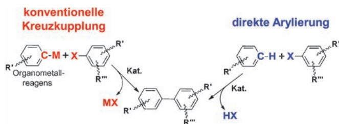
Schema 2. Synthese von \pi -konjugierten Polymeren durch konventionelle Kreuzkupplung und direkte Arylierung im Vergleich. M = \text{SnR}_3 , \text{B(OR)}_2 , \text{MgX} , \text{ZnX} , \text{Cu} etc.; X = Cl, Br, I, \text{OSO}_2\text{R} .
